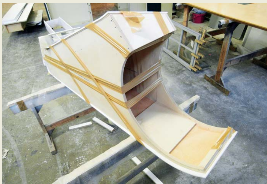
Formteilstrategie. Neben dem Verkaufstresen stellt auch die Gestaltung der Stütze im Kundenbereich einen Blickfang der Airport Apotheke dar. Die Verkleidung besteht aus 6 Segmenten.
