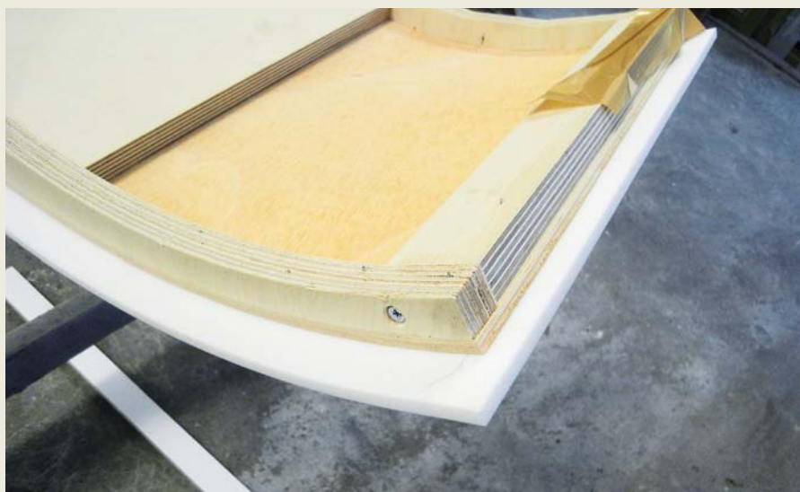
Spantenkonstruktion. Die Formteile sind als Spantenkonstruktion aufgebaut. Dadurch sind sie leicht und lassen sich problemlos transportieren.
