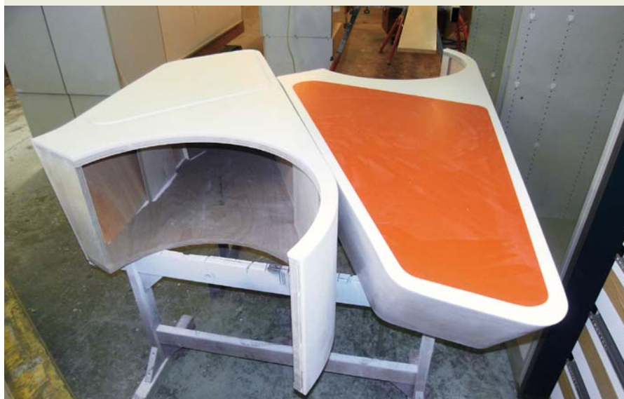
Design. Die Oberfläche der Ummantlung der tragenden Stahlbetonstütze sowie der auskragenden Elemente besteht aus Hi-Macs von LG.
